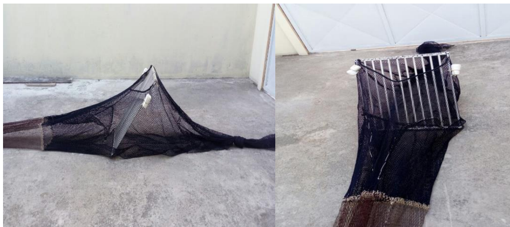
Figura 7. Dispositivo de exclusão com grade de alumínio instalado antes do saco da rede (DEGA).
