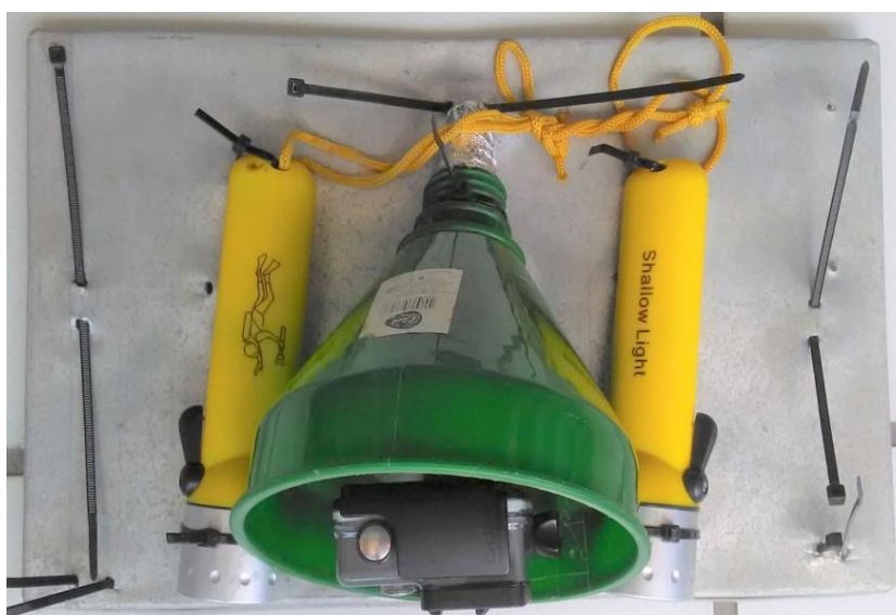
Figura 1. Sistema de fixação da câmera subaquática e lanternas na rede de arrasto.
