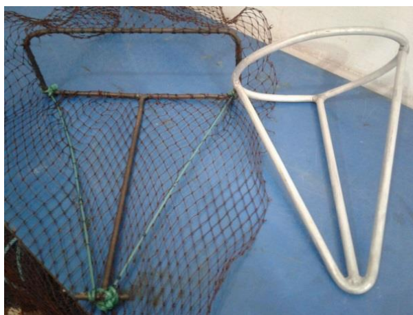
Figura 5. Dispositivo adaptado “Janela de escape” e um Fisheye de alumínio (DJE-S).
