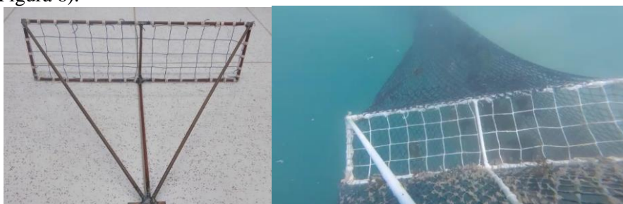
Figura 6. Dispositivo janela de escape com malhas quadradas no saco da rede (DJE-MQ-S).
