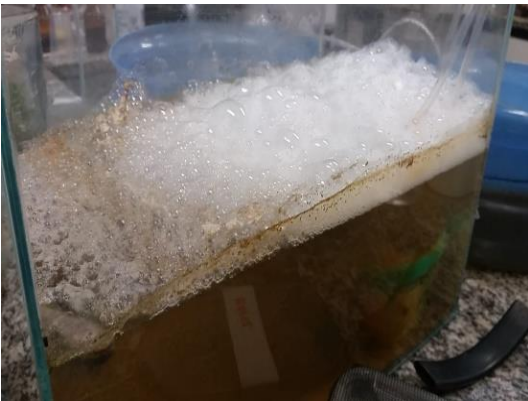
Figura 4. Sistema 2: Extrato de Moringa macerada com biofiltro de cascalho
