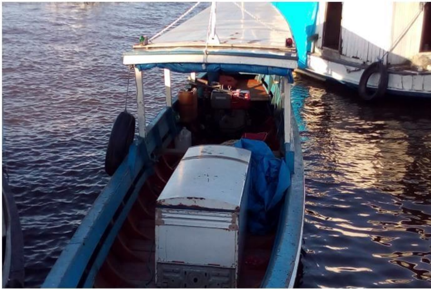
Figura 16. Bajara no cais do Porto dos Milagres, em Santarém, estado do Pará, transportando pescado resfriado e conservado dentro de carcaças de geladeiras abastecida com gelo, em Santarém, Baixo Amazonas, estado do Pará.
