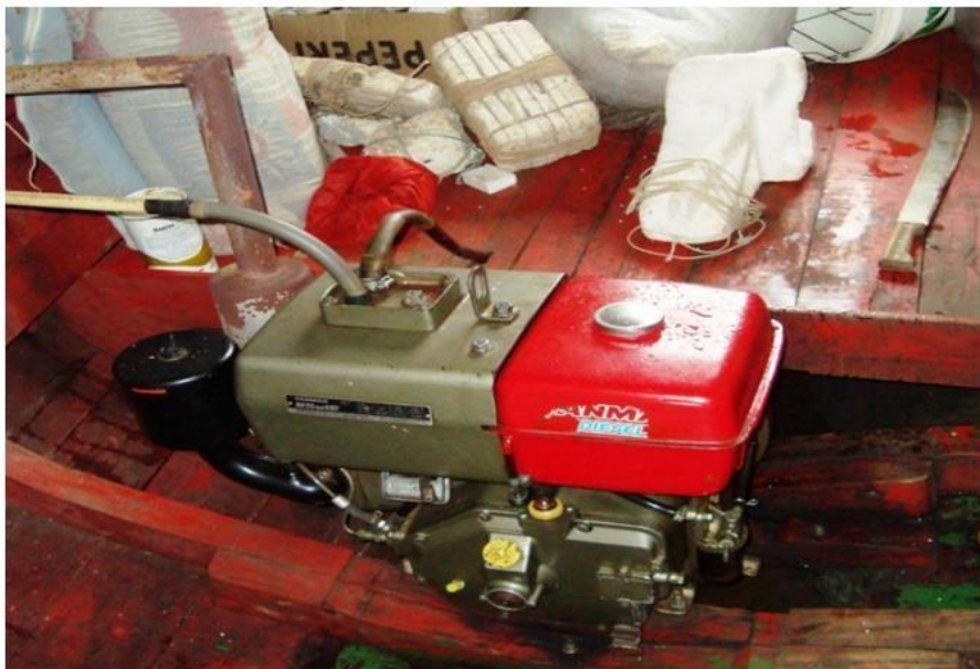
Figura 15. Motor de centro utilizados em bajaranas e barcos geleiros, em Santarém, Baixo Amazonas, estado do Pará.
