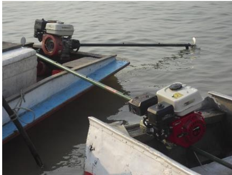
Figura 8. Motores do tipo rabeta utilizados nas canoas para a prática de pesca em Santarém, Baixo Amazonas, estado do Pará.
