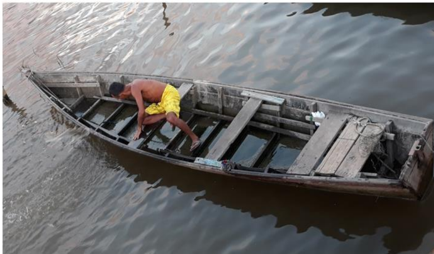
Figura 13. Canoa do tipo sapiara (fundo chato) utilizada em atividade de pesca em Santarém, Baixo Amazonas, estado do Pará.
